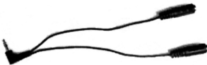
Collegamento a stella a due uscite per sensori esterni (soltanto nei modelli EG e AT)
