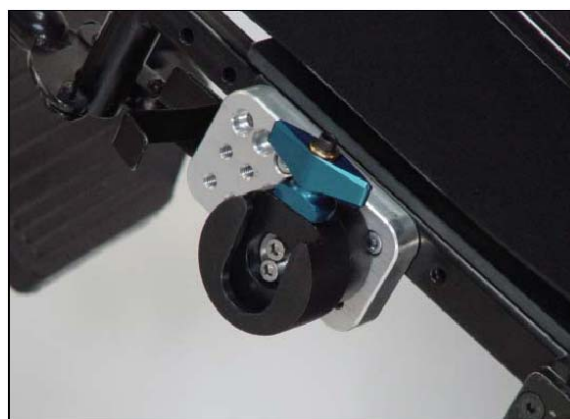
Fig. 2 - A fianco è raffigurato un ancoraggio ad una carrozzina basculante.
