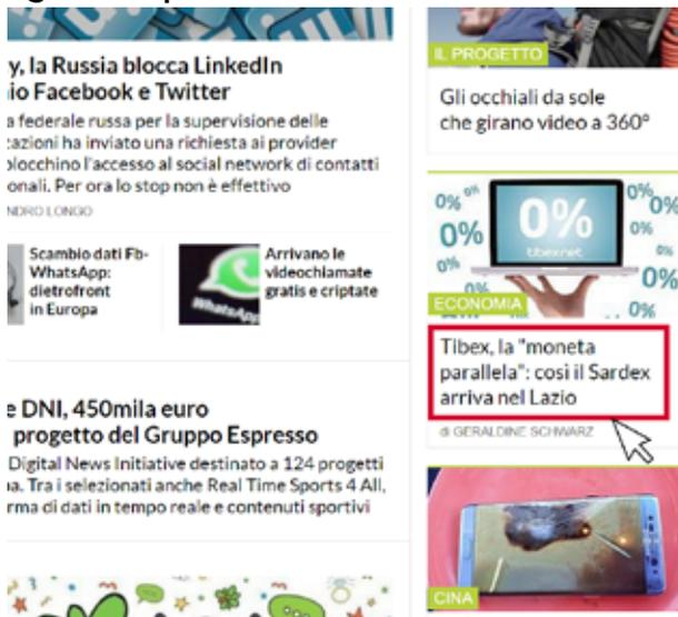
SimplyMouse è la risposta a quanti desiderano un sistema funzionale e più avanzato per la navigazione Internet e il controllo del computer. Grazie a un algoritmo innovativo SimplyMouse riconosce il bersaglio che l'utente sta guardando; lo evidenzia con una cornice e attira magneticamente il puntatore del mouse, facilitando l'operazione di click. Anche i bersagli più piccoli in questo modo risultano selezionabili in modo più agevole.
