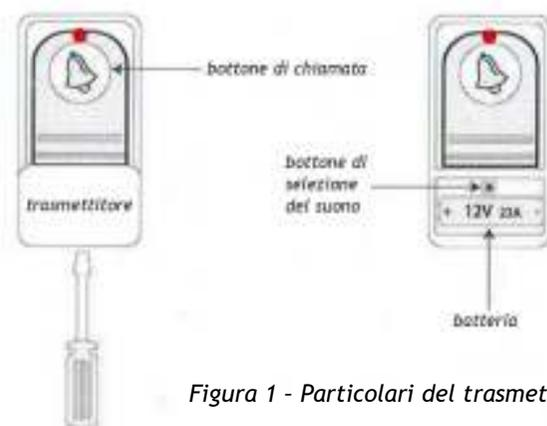
Figura 1 - Particolari del trasmettitore
