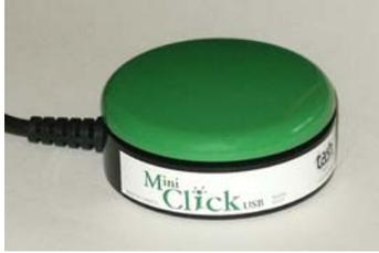
USB MiniClick è costituito da un pannello con circuito elettronico fissato su una base di Buddy Botton. Quando è attivato, il MiniClick svolge le funzioni del clic sinistro del mouse. L'unità ha una presa USB.
